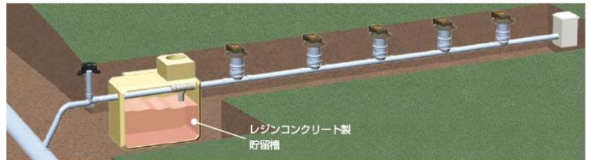
マンホールトイレの下水構造図
