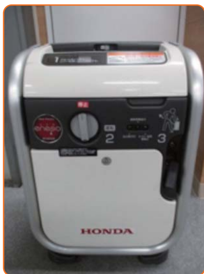
ガスボンベ式発電機
